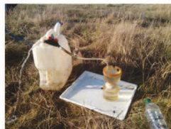
Відбір проб вод через фільтраційну установку NALGENE
